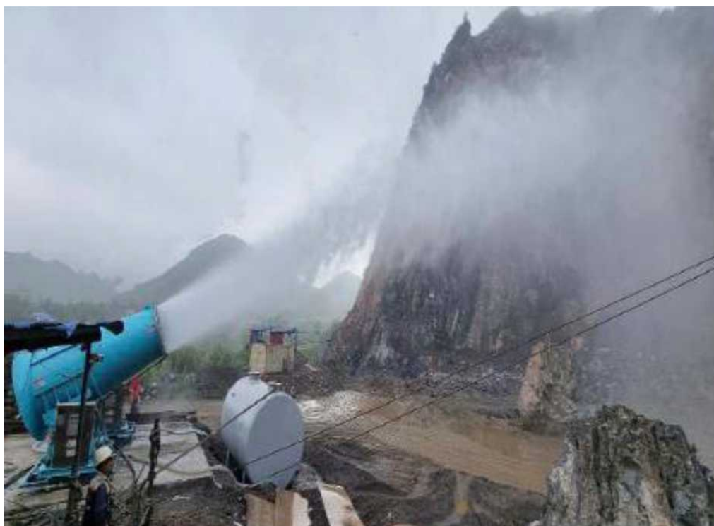
Hình 3-6: Hình ảnh minh họa máy dập bụi tại dự án
